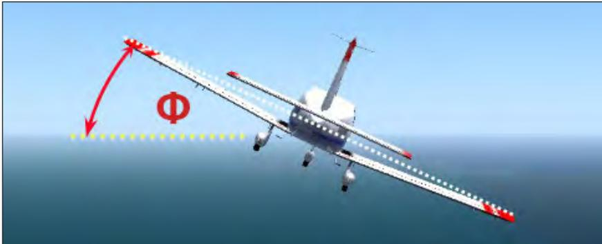
L'inclinaison de l'avion symbolisée par la lettre grecque phi ( $\Phi$ ), est l'angle compris entre l'horizontale et le plan moyen des ailes de l'avion.
