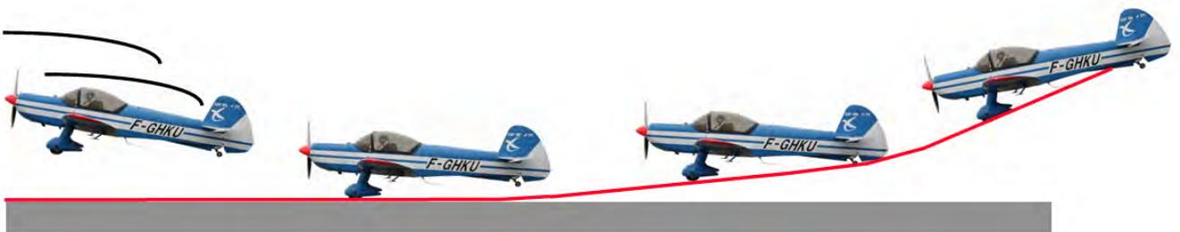
La prise de contact accidentelle du train principal suite à un atterrissage deux points va créer un couple « *cabreur* » (augmentation d'incidence) d'où une tendance au rebond. Dans ce cas, il conviendra d'appliquer la procédure décrite au paragraphe « atterrissage manqué ».
