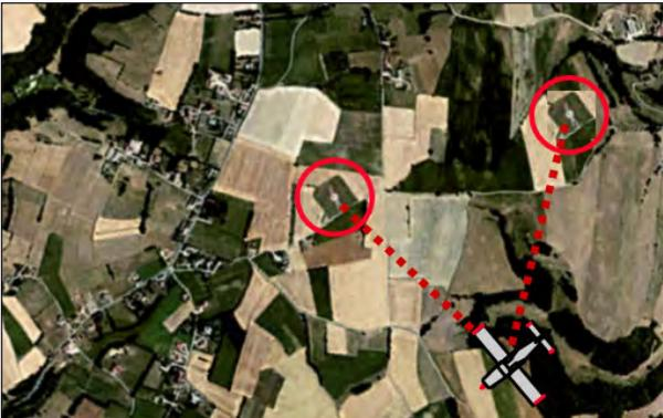
Une plus grande précision est obtenue en utilisant 2 VOR permet-tant de trouver sur quelle intersection se situe l'appareil.
