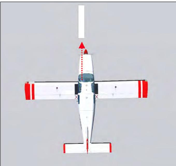
Un bon alignement est obtenu lorsque le pilote est assis sur l'axe réel ou imaginaire de roulement : ceci afin d'éviter l'erreur de paralaxe.
