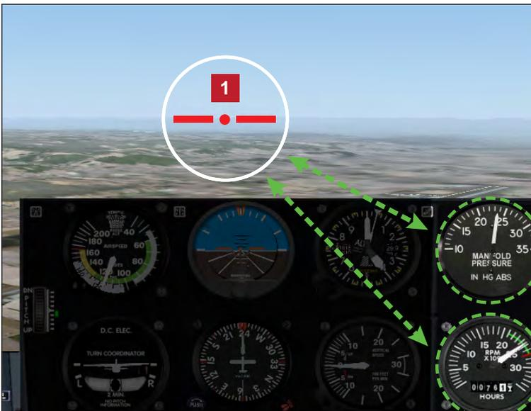
En VFR il comprend le **RPB comme élément principal**, l'horizon, l'environnement extérieur et quelques instruments de pilotage à l'intérieur de la cabine.
