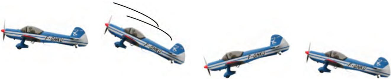
**1** - Avion stabilisé à 1.45 de Vs estimée à la hauteur de sécurité
