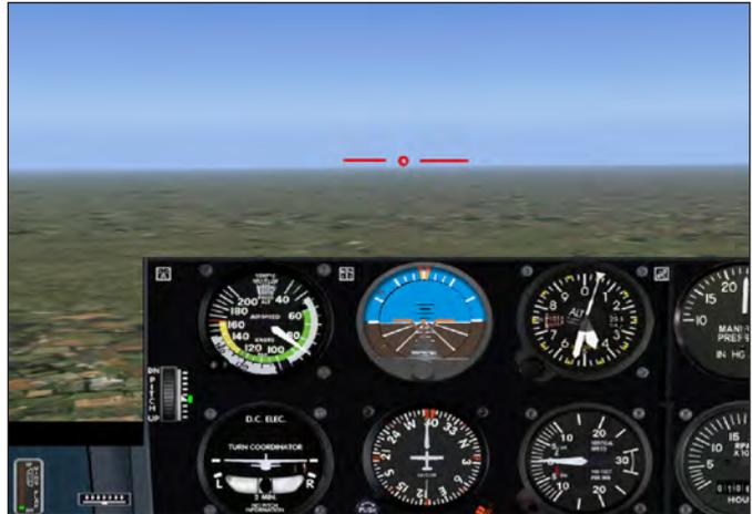
Préparer l'avion pour la descente : avion stabilisé en configuration atterrissage à 1.45 Vs0 en palier ou en légère descente.
